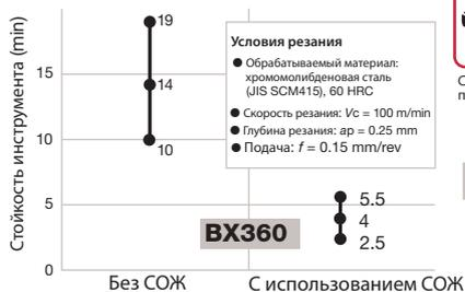
● При обработке без прерываний резание с СОЖ превосходит резание без СОЖ в стойкости к износу
