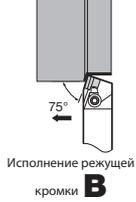
Исполнение режущей кромки <b>B</b>                          | CSBNR/L2020 | ●       |   | 20           | 20 | 125            | 31             | 20             | 17   | -              | 0.8 | SN□□1204□□<br>90°□ ▶ 2-69            |
