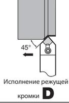
Исполнение режущей кромки <b>D</b>              | CSDNN2020   | ●       |   | 20           | 20 | 125            | 32             | 20             | 10.0 | -              | 0.8 | SN□□1204□□<br>90°□ ▶ 2-69            |
