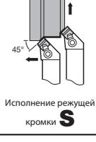
Исполнение режущей кромки <b>S</b> | CSSNR/L2020 | ●       | ● | 20           | 20 | 125            | 31             | 20             | 25   | -              | 0.8 | SN□□1204□□<br>90°□ ▶ 2-69            |
