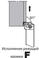
Исполнение режущей кромки <b>F</b>                        | CTFNR/L2020 | ●       | ● | 20           | 20 | 125            | 22             | 20             | 25   | -              | 0.8 | TN□□1604□□<br>60°△ ▶ 2-79            |
