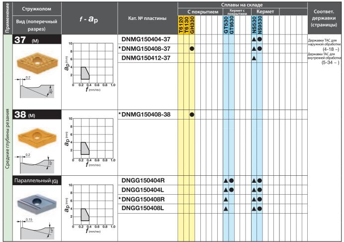
Примечание: поперечные разрезы стружколомов представлены для пластин, отмеченных звездочкой \*.
